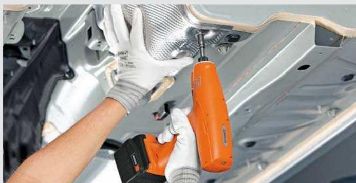
La vitesse de rotation reste constante jusqu'à l'obtention du couple de serrage pré-réglé.
